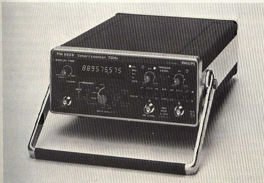
Fig. 10 - La serie PM 6620 è intesa prevalentemente per l'esecuzione di misure di tempi: la foto rappresenta il contatore e misuratore dei tempi tipo PM 6625, da 1 GHz.
