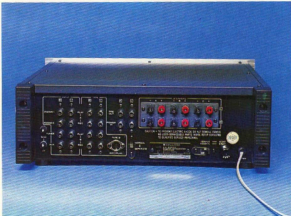
Pannello posteriore dell'amplificatore Kenwood KA-8300. Si nota in particolare i sei morsetti per il collegamento di tre coppie di casse commutabili da un apposito comando situato sul pannello frontale.
